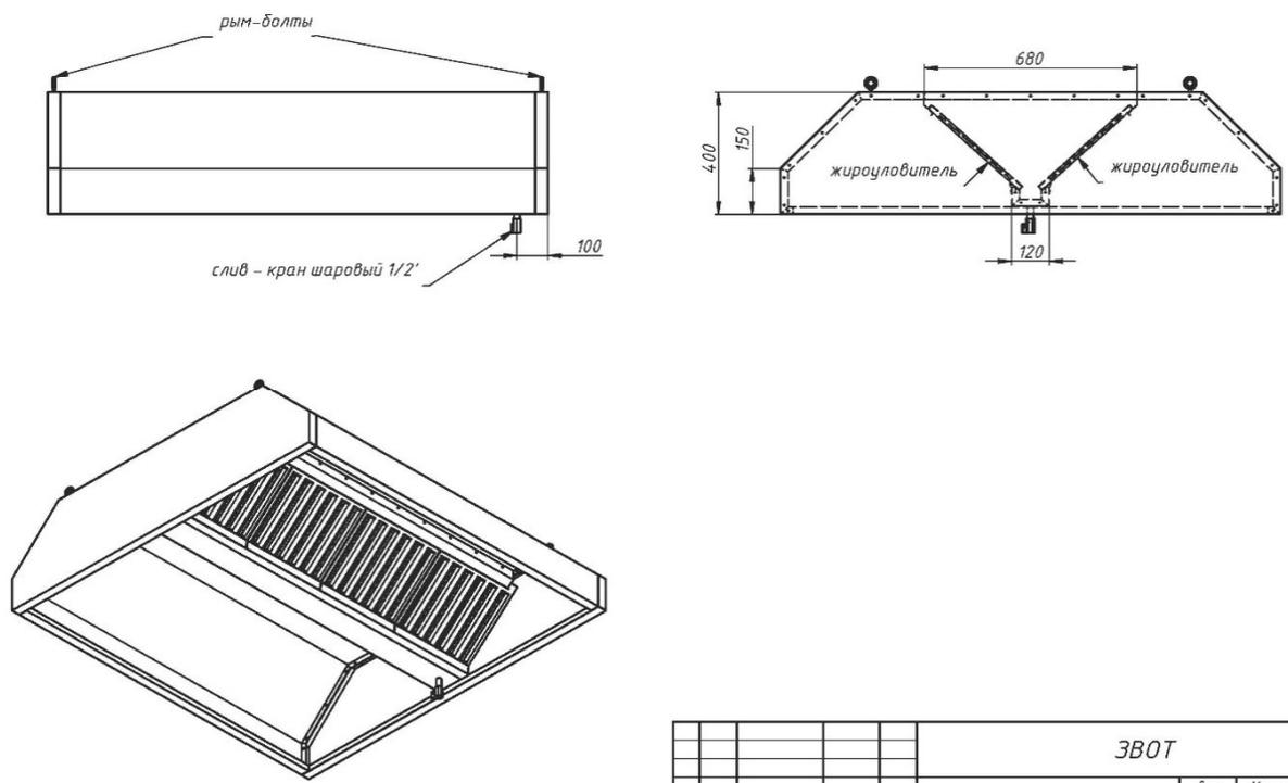
**\*ШИРИНА ЗОНЫ ВЫТЯЖКИ ЗОНТОВ ЗВОТ - 680ММ**
